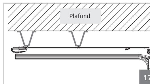
← **Remarque** • Si vous ne pouvez pas fixer le rail au plafond pour ne pas respecter les mesures ci-dessus, vous devez créer une structure solide pour être en mesure de fixer dans les mesures correctes. Cette structure peut être fixée au plafond, comme visible dans l'image 17.
