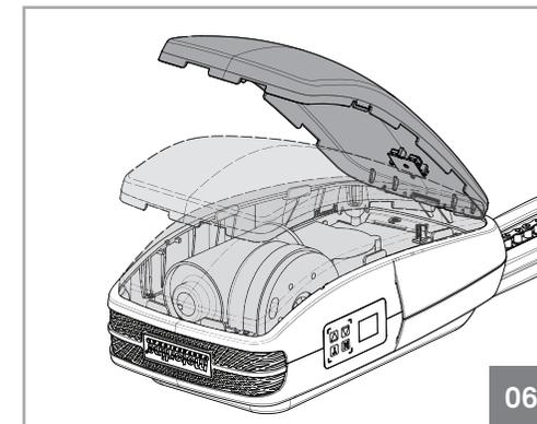
Pour enlever le couvercle il suffit d'insérer un petit tournevis dans les trous latéraux et de créer un effet de levier pour libérer les fentes entre le couvercle supérieur et le corps du moteur. Ensuite, il suffit de retirer le couvercle en le soulevant.
