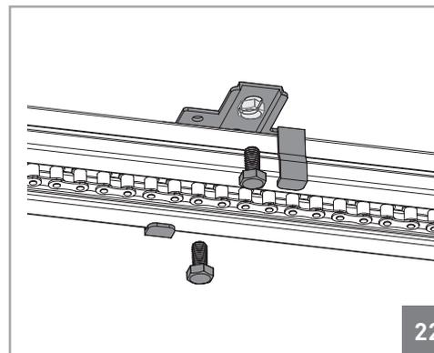
**05** • Après avoir monté le rail et marqué les trous vous devez fixer la plaque avec des vis. Après cela, vous devez utiliser la brassière de serrement pour renforcer la fixation, cette fois-ci à la proximité du moteur (image 23).
