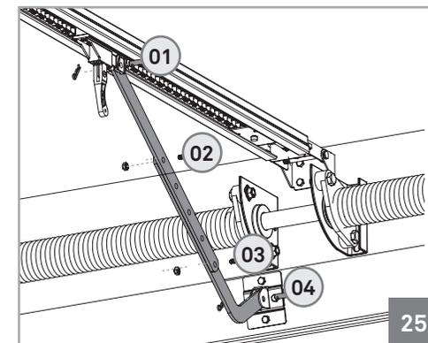
**07** • Fixez maintenant les deux plaques de liaison entre le chariot et la plaque du panneau supérieur. Utilisez les vis et femelles M8 pour serrer les 2 plaques ensembles (**02** et **03**), et les deux chevilles et les freins pour les fixer dans le chariot et la porte (**01** et **04**).
