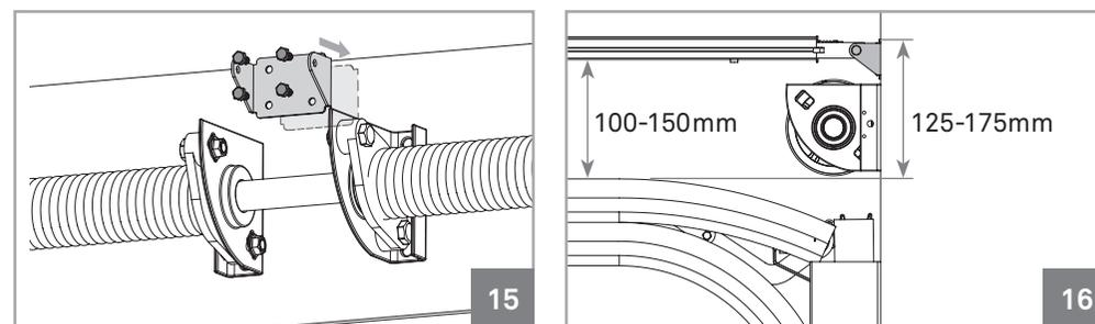
01 • Fixer la **plaque de support du rail au linteau**, comme visible sur l'image 15. Dans l'image 16 se voit la distance à garder entre le rail du portail et la partie supérieure de la plaque de support (125-175mm).
