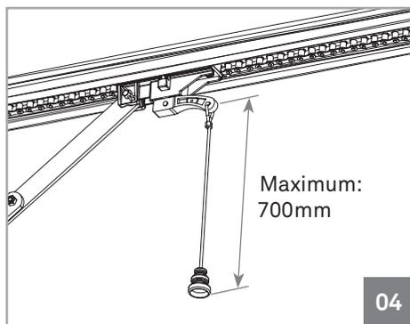
← Avec cet automatisme est également fourni un cordelette pour application sur le levier de déverrouillage, ce qui rend encore plus pratique et commode le processus.
