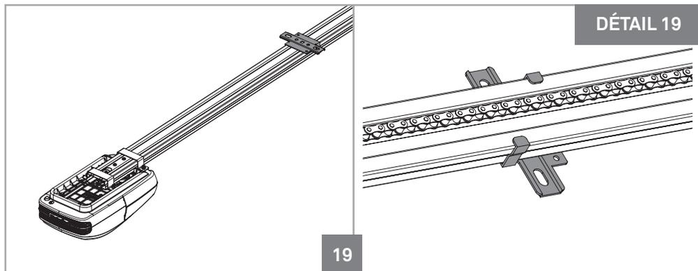
**03** • Placer la **plaque de fixation du rail au plafond**, plus sensiblement au milieu du rail en fer, comme dans les images ci-dessus.
