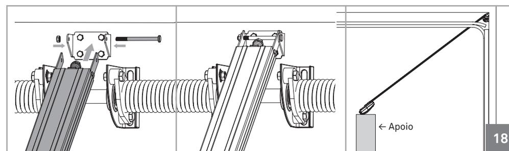
02 • Si vous ne pouvez pas fixer le rail au plafond pour ne pas respecter les mesures ci-dessus, vous devez créer une structure solide pour être en mesure de fixer dans les mesures correctes. Cette structure peut être fixée au plafond, comme visible dans l'image sur le côté gauche.
