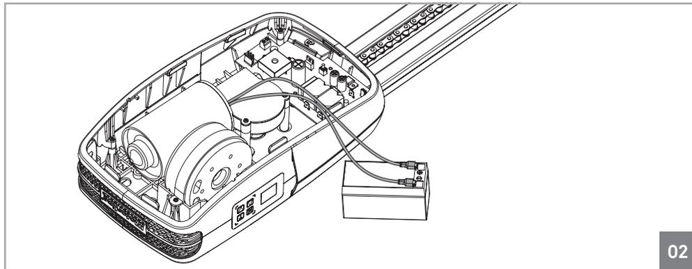
Les câbles du moteur n'ont pas un sens de connexion spécifique. La seule différence c'est que, en connectant d'une façon le moteur tourne dans une direction, et en connectant dans le sens opposé il tourne dans l'autre sens.
