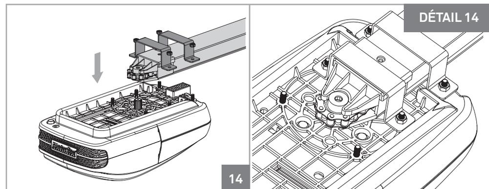
02 • La fixation du rail en aluminium, dans l'automatisme, doit être fait en utilisant les plaques et les femelles M6, comme indiqué ci-dessus. Vous devez serrer en 4 vis en laissant les deux de l'avant libres.
