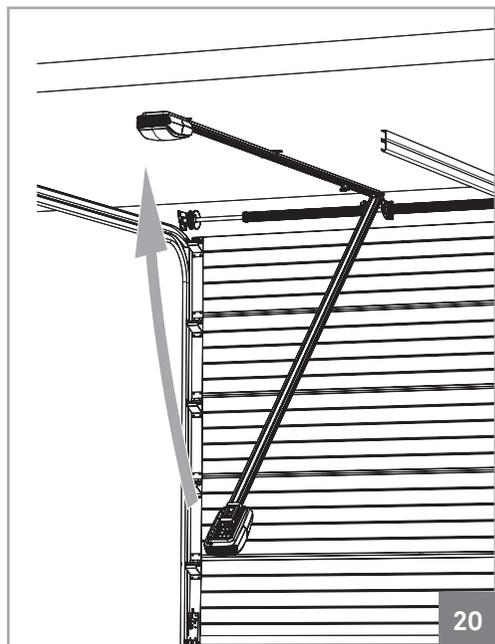
**04** • Montez le moteur jusqu'à ce que le rail reste, horizontalement, nivelé.
