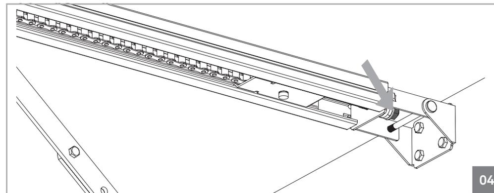
Afin que l'automatisme fonctionne correctement, la chaîne doit être bien ajustée. Pour cela, il vous suffit de serrer ou desserrer la femelle ombragée, sur l'image ci-dessus, à l'aide d'une clé et fera que la chaîne s'étende ou se soulage. La chaîne ne doit pas être trop tiré car ça peut se coincer et endommager le motoréducteur, ni trop lâché au point de s'affaisser au milieu et sortir du rail.
