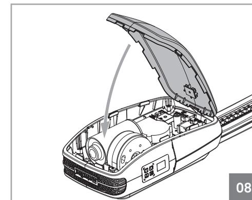
Pour remplacer le couvercle vous devez, tout d'abord, emboîter la partie arrière, comme dans la figure 07. Après il suffit de tourner le couvercle et d'emboîter la partie avant en appuyant vers le bas. Les emboîtements seront automatiquement fixés au couvercle.
