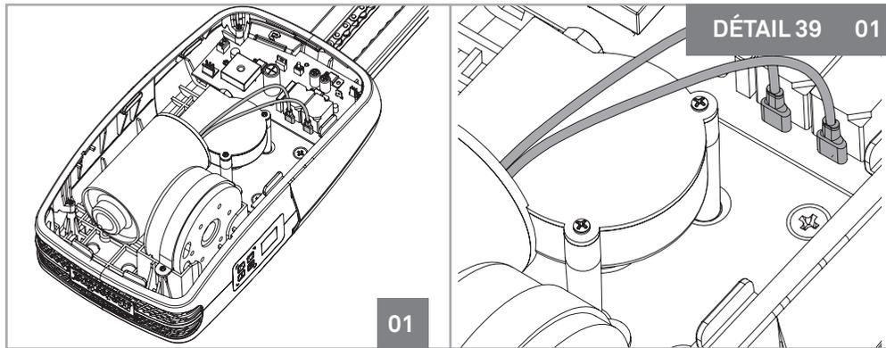
En cas de panne ou de dysfonctionnement de l'automatisme, vous devez détecter le composant défectueux (moteur ou centrale). Pour cela, vous devez tester le moteur directement connecté à une alimentation à **24DC**, afin de comprendre si cela fonctionne. Il suffit de débrancher les deux fils du moteur (ombragés sur l'image 01) qui se connectent à la centrale et les connecter directement à un batterie de **24DC** comme visible dans l'image 02.
