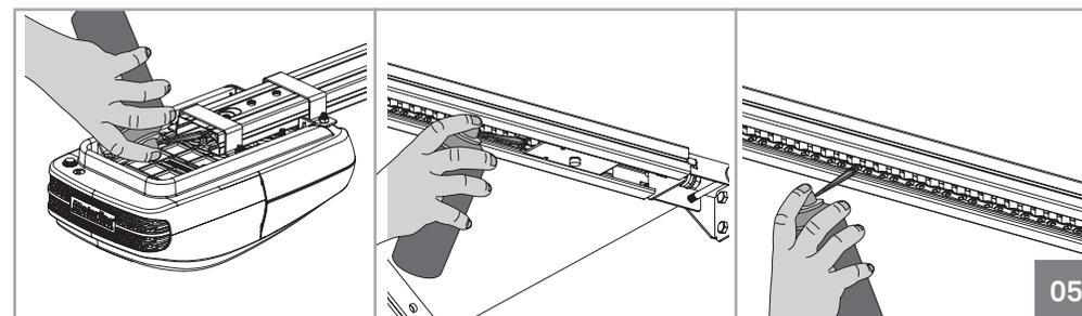
Le seul entretien nécessaire c'est de lubrifier les axes de mouvement de l'automatisme et du rail. Les pignons sur deux extrémités des rails et leurs couronnes de support et la chaîne doivent être lubrifiés au moins une fois par an.
