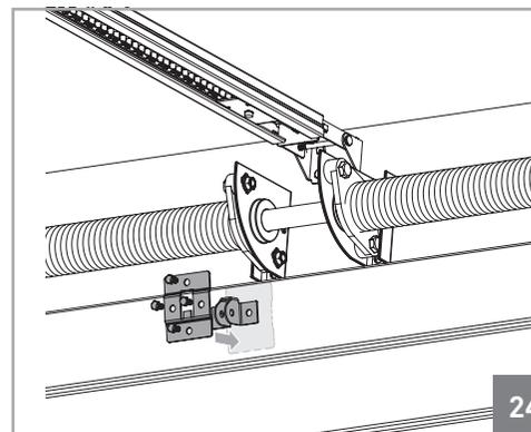
**06** • Fixez la plaque sur le panneau supérieur de la porte. La plaque doit être centré horizontalement avec le panneau de façon à être aligné avec le rail.
