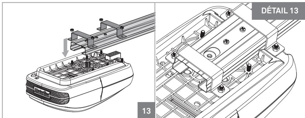
01 • La fixation du rail en fer, dans l'automatisme, doit être fait en utilisant les plaques et les femelles M6, comme indiqué ci-dessus. Vous devez serrer en 4 vis en laissant les deux du milieu libre.
