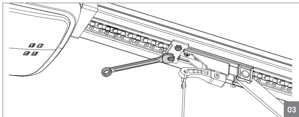
• Pour installer le butée d'ouverture il suffit de le placer dans le rail, comme on le voit sur la figure 01. Le butée doit rester avec une plaque hors du rail et l'autre à l'intérieur car, lors du serrement, celui doit rester bien fixe au rail.
